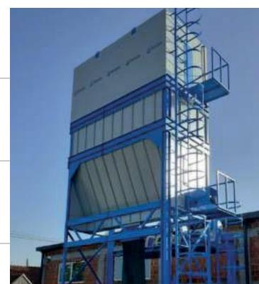
**16-17 4000 m<sup>3</sup>/h Mobil Toz Filtre Makineleri**
